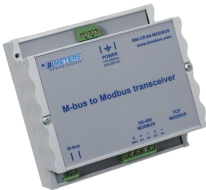
El MB-CR-64 es un microcontrolador basado en microcontrolador M-bus maestro a Modbus RS-485 RTU y / o Modbus TCP. Puede suministrar energía a un máximo de 64 dispositivos esclavos de bus m. MB-CR-64 se utiliza como puente en redes de edificios e industriales donde se necesita para leer dispositivos de bus m (taxímetros y / o sensores) en sistemas SCADA basados en Modbus. Tiene protección de cortocircuito de salida en el lado del bus m. Se monta en el carril estándar M36 DIN.
