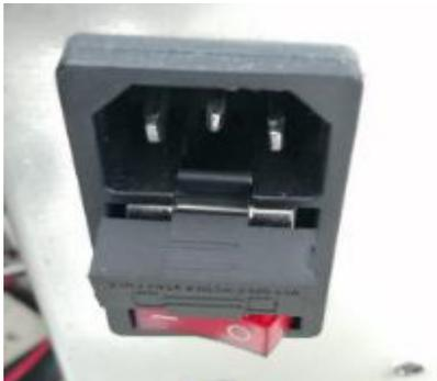
**Seguridad eléctrica:** la estufa está protegida contra los saltos bruscos de corriente por un fusible (3,15 A.) general que se encuentra en el pequeño panel de mandos ubicado en la parte trasera de la estufa. Hay otros fusibles para la protección de las tarjetas electrónicas (tarjeta madre y tarjeta intercambiador) que están situados en éstas últimas.
