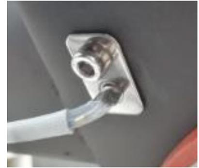
**Sensor temperatura humos:** termopar que mide la temperatura de los humos mientras se mantiene el funcionamiento o apaga la estufa cuando la temperatura del gas de combustión cae por debajo del valor preestablecido.
