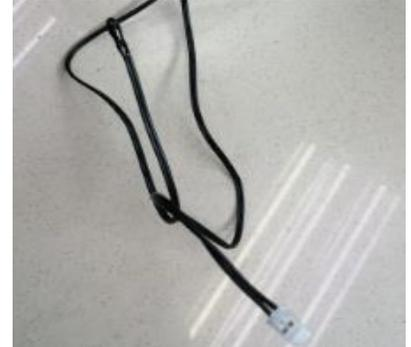
**Termostato ambiente:** el termostato de ambiente detecta la temperatura presente en la sala. Cuando se detecta el ajuste de la temperatura en la pantalla, la estufa se pone en funcionamiento en ECO es decir, la función de retención para ahorrar combustible. El termostato ambiente se condiciona por la temperatura del cuerpo de la estufa.
