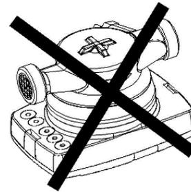
No se admite el montaje del contador con la unidad electrónica orientada hacia abajo (ver la figura siguiente).
