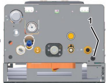
**Comentario:** El vaciado total del sistema se puede alcanzar solo descargando el sistema del punto más bajo.
